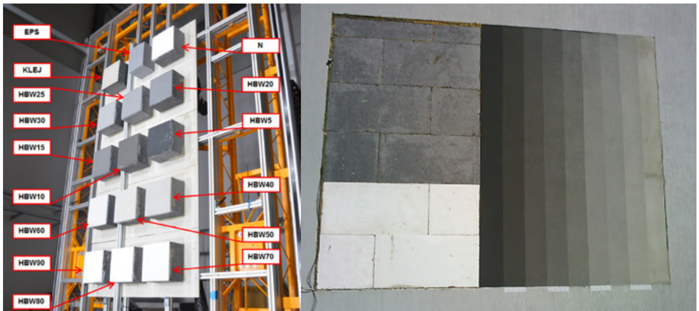
Fot. 1. Stanowisko laboratoryjne i polowe badań rozkładu temperatury na powierzchni tynków.
